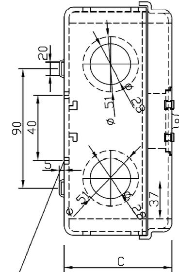
Luva em latão para parafusos de fixação do suporte do disjuncter.
